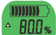
Lorsque le courant de charge ou de décharge est inférieur au courant nécessaire à l'écran pour alimenter le rétro-éclairage, le coulombmètre passe dans un état de veille et éteint le rétro-éclairage.
