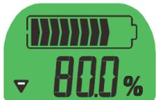
Lorsque le courant de charge est supérieur au courant nécessaire à l'écran pour alimenter le rétro-éclairage, l'indicateur plus s'affiche.
